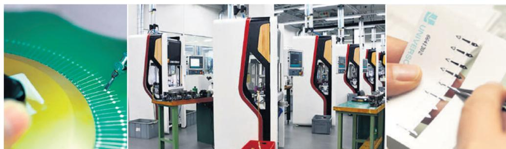
**MILLIMETERARBEIT:** Uhrenarbeiterin Zaslowski bearbeitet die filigranen Zeiger, die zuvor aus Metallstreifen geschnitten wurden. Zum Schluss werden die Zeiger auf einer Karte plziert und mit einer Lupe genauestens kontrolliert. FOTOS: PD
