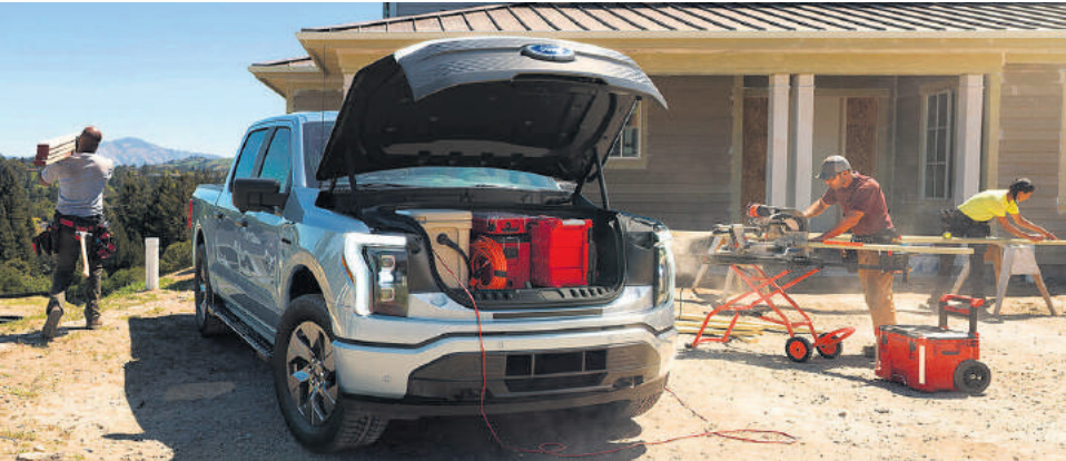
ELEKTRO-MONSTER: Der F150 Lightning verbraucht statt 12 Liter Benzin auf 100 Kilometer nur 20 Kilowattstunden und beschleunigt in weniger als 5 Sekunden auf 100 km/h. FOTO: PD
