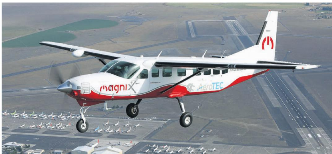
LEISE FLIEGT SIE DURCH DIE LÜFTE: Die erste elektrische Cessna Grand Caravan. FOTO: MAGNIX
