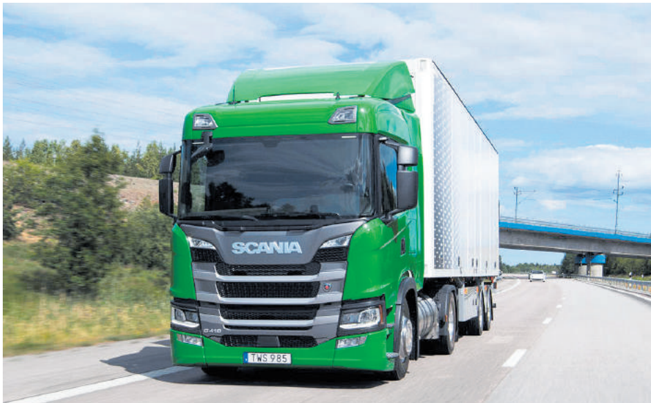
GAS GEBEN MIT GAS: Der Scania-Flüssiggasantrieb kommt ohne weitere Treibstoffe aus. Das heisst konkret: 0 Prozent Diesel, 55 Prozent weniger Stickoxide, 50 Prozent weniger Lärm und 15 Prozent weniger CO 2 . FOTO: SCANIA
