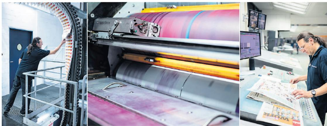
**HIER WIRD WORK GEDRUCKT:** Tyrone Stevenson kontrolliert die Druckqualität und legt selbst Hand an, wenn die Mischung aus Farbe und Wasser nicht stimmt.
