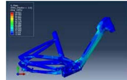
Kernstück des Rahmens ist die Torsion Box. Die **Torsion (Filter) Box** leitet Torsionskräfte von der Motoraufhängung, dem schwächsten und am meisten belasteten Punkt des Rahmens ab und verstärkt den Rahmen strukturell über ihr one-piece Design, welches in Sitzrohr, Unterrohr und Kettenstreben übergeht.
