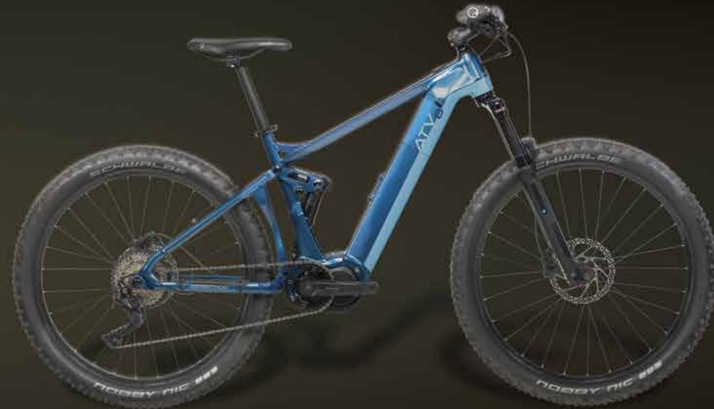
Das Velo wird vom Shimano 8000 angetrieben und mit **Deore** geschaltet. Das Floating E-VPP wird vom **RockShox Deluxe RL Dämpfer** und der **Suntour AION 140 mm Federgabel** hervorragend unterstützt. Ergreifend klassisch in 2-tone-navy-blue-metal.
