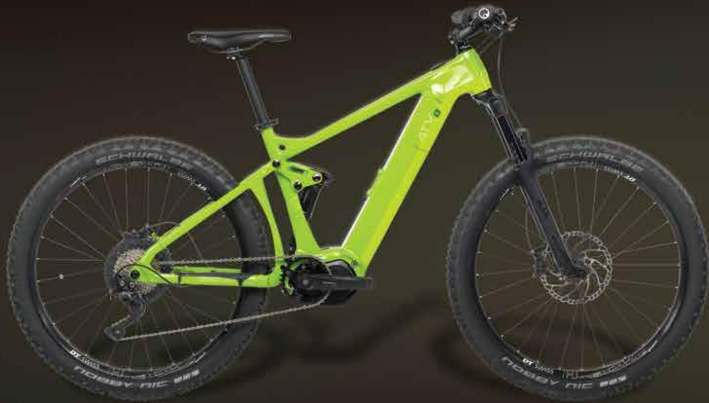
Der ATV 3-Kammer-Rahmen, mit 500 Wh SnakePack und Shimano E8000 verfügt mit 35 mm tapered Headtube über sehr gute Steifigkeit. Die **RockShox Revelation 140 Federgabel**, **Shimano XT/SLX**, sowie die **DT Swiss H1900** Laufräder runden das Trailpaket ab. Farblich kommt es in 2-tone-lime-grün.
