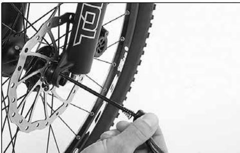
2. Setzen Sie die Feder und die Schraubenmutter auf die Achse. Drehen Sie auf das rechte Ende, das jetzt aus der Nabe heraussteht, die Schraubenmutter im Uhrzeigersinn.
