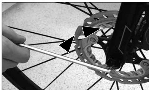
3. Anschließend fixieren Sie die Steckachse nach den Vorgaben des Herstellers mit einem Drehmomentschlüssel.
