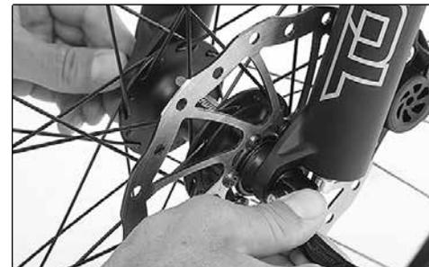
5. Drehen Sie die Schraubenmutter bzw. den Innensechskant nun soweit, bis sich der exzentrisch gelagerte Hebel bei einer Drehung um seine Lagerung ab 90° nur noch gegen einen Widerstand bewegen lässt (er bildet so die ungefähre, geradlinige Verlängerung der Nabenachse).
