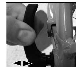
3. Durch loslassen des RWS-Spannhelms rastet dieser dann an der gewünschten Position sicher ein. Achten Sie auf einen festen Sitz und die geeignete Positionierung des Spannhelms. Bitte entnehmen Sie die korrekte Positionierung und deren Einstellung der Bedienungsanleitung des jeweiligen Schnellspanner-Steckachsen Herstellers.
