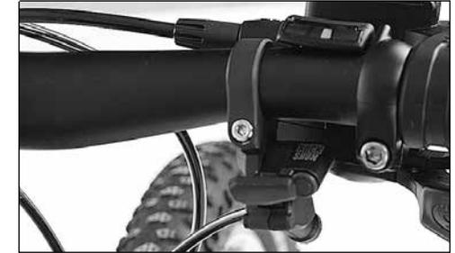
2. **Verfügt Ihre Gabel über einen Feststellmechanismus, wie auf dem Bild zu sehen, entnehmen Sie dessen Bedienung der beiliegenden Komponentenbedienungsanleitung des Federgabelherstellers.**
