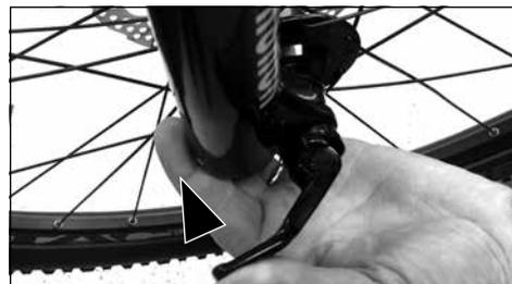
3. Achten Sie auf einen festen Sitz und die geeignete Positionierung des Spannhelms. Bitte entnehmen Sie die korrekte Positionierung und deren Einstellung der Bedienungsanleitung des jeweiligen Schnellspanner-Steckachsen Herstellers.
