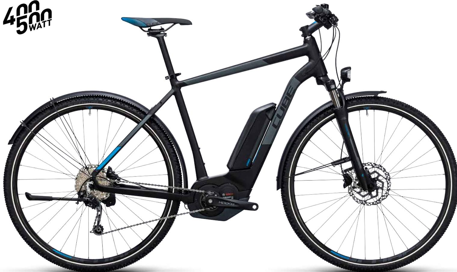
Das Cross Hybrid Pro Allroad 400 ist ein zuverlässiges Cross-Pedelec mit großem Einsatzspektrum - ob sportliche Touren, der Alltagseinsatz oder gemütliche Ausflüge in die Natur. Dank Rückenwind durch den kräftigen Bosch Antrieb, dem hochwertigen und für 2017 neu entwickelten Aluminium Rahmen oder der grundsoliden Ausstattung, inklusive hydraulischer Scheibenbremsen, ist es ein idealer Begleiter für alle Genussradler, die ein Höchstmaß an Fahrsicherheit und Komfort auf allen Wegen suchen.
