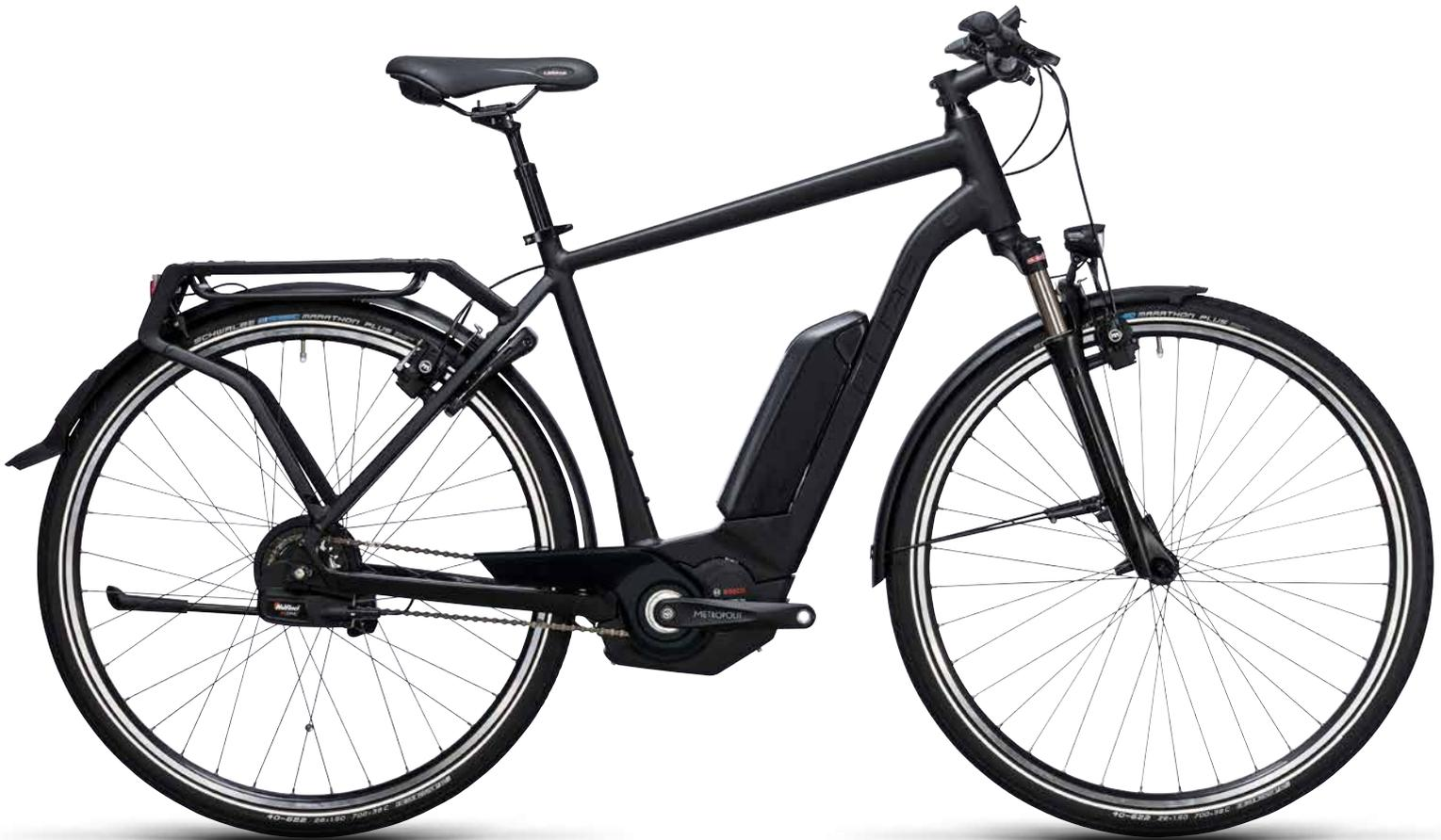
Perfektion bis ins kleinste Detail und eine bei einem Urban-Pedelec bislang unerreicht exklusive Ausstattung - das ist unser Delhi Hybrid SL. Mit der komfortablen Suntour Federgabel, der wartungsarmen und automatisch schaltenden NuVinci H|Sync Nabenschaltung und dem starken Bosch Performance Line Antrieb, inkl. großem 500Wh Akku, sind nur die herausragenden Highlights dieses Ausnahme-Bikes erwähnt. Ein E-Bike zum Verlieben - für technikaffine Vielfahrer und Genießer.
