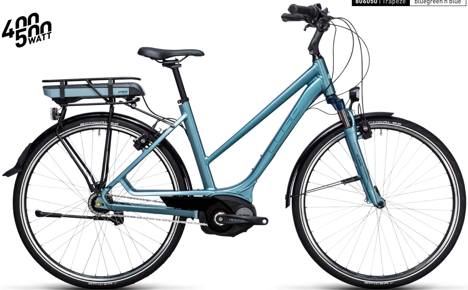
E-Bikes sind auf dem besten Weg, den Individualverkehr zu revolutionieren. Mit der gewohnt hohen CUBE-Qualität, wird das neue Travel Hybrid ONE diese Revolution definitiv noch einmal vorantreiben. Mit der 7-Gang Getriebenabe, dem hydraulischen Bremssystem von Magura und der komfortablen Federgabel ist es das ideale Rad für sorgenfreie Fahrten im Alltag und darüber hinaus.
