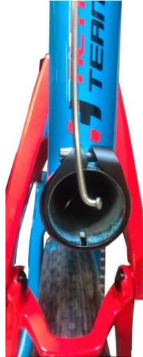
3. Draht aus Sattelrohr ziehen !
