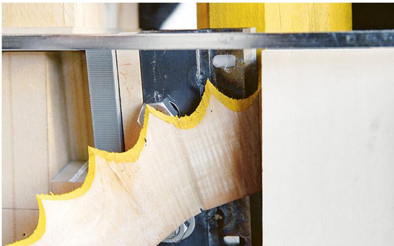
Durch das Anspitzen des Holzes entsteht ein übergrosser Span.
