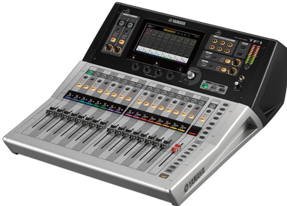
Mit diesem Digitalen 16 Kanal-Mischpult können alle Elektronischen Tonquellen gemixt und zu den Endverstärker geleitet werden.
