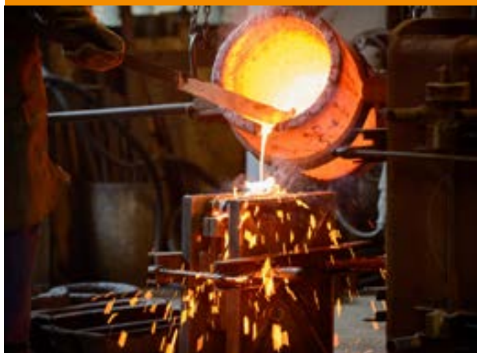
Fusione di una campana nella ditta Rüetschi. (Fotogr.: © Rüetschi, Aarau)
