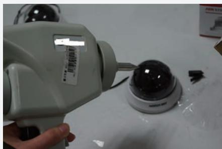
Prüfeinrichtung für elektrostatische Entladung/Anti-Interferenz
