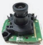
Hikvisions nahtlose Konstruktion mit integriertem Objektiv
