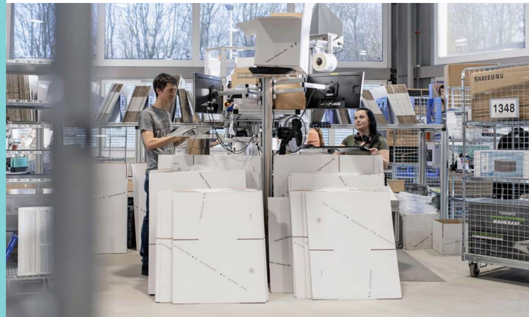
Les machines entièrement automatisées de Digitec Galaxus emballent les commandes sur mesure et sans matériau de remplissage.
