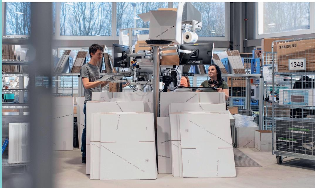
Le macchine completamente automatizzate di Digitec Galaxus confezionano gli ordini su misura e senza materiale di riempimento.
