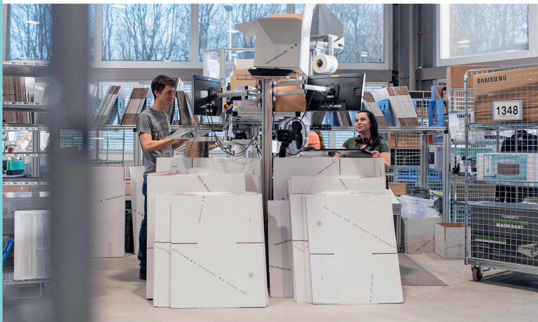
Die vollautomatischen Maschinen von Digitec Galaxus verpacken die Bestellungen auf Mass und ohne Füllmaterial.
