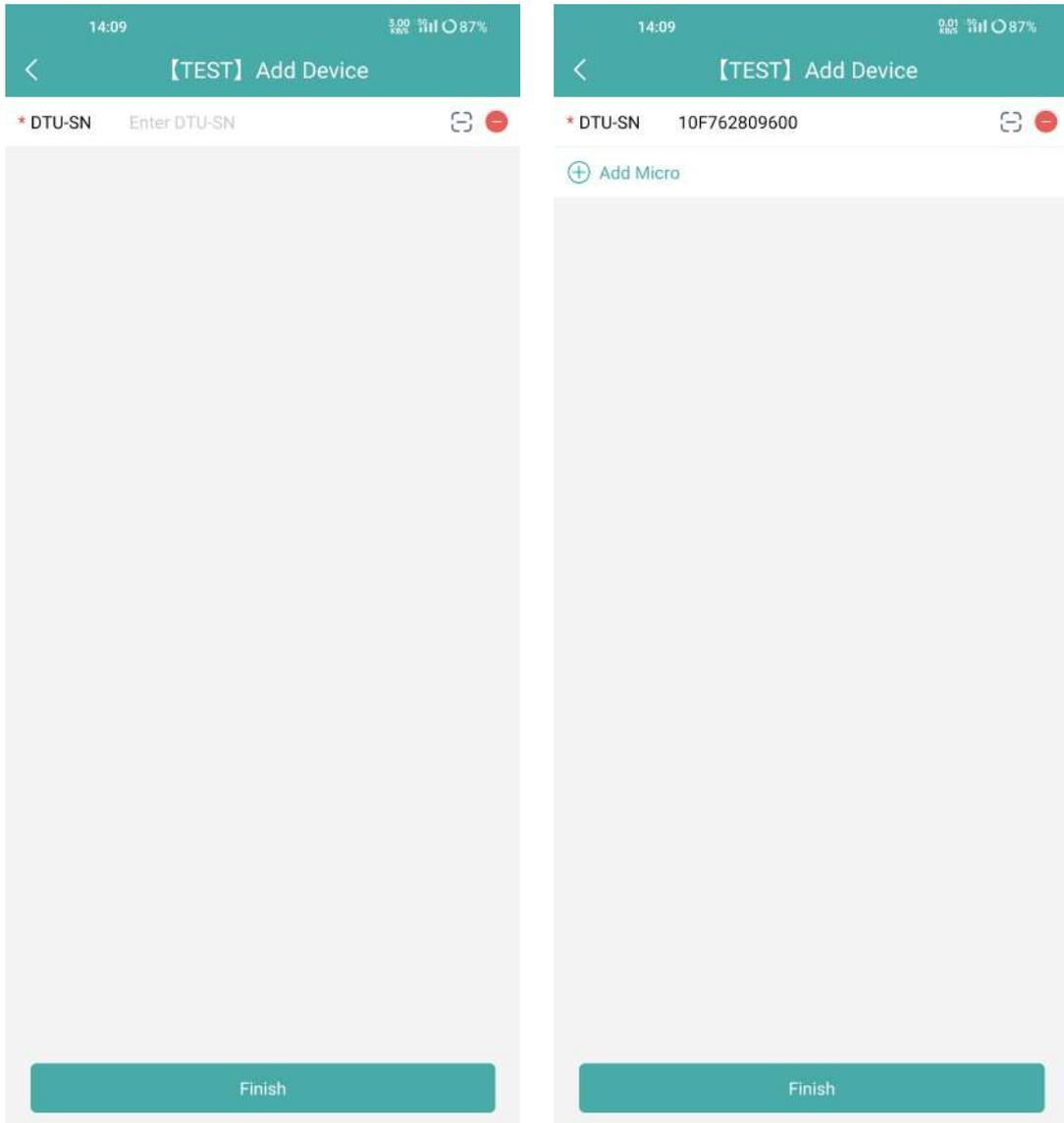
9) Fügen Sie Ihren Mikro-Wechselrichter hinzu, indem Sie die SN des Mikro-Wechselrichters manuell eingeben oder den SN-Aufkleber auf dem Gerät scannen.
