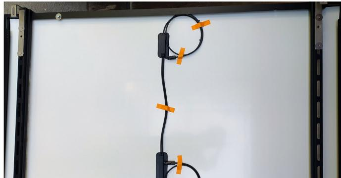
Wechselrichter an der linken (wenn links am Panel montiert, sonst an der rechten) Aussparung mit dem Schraubenset (2) befestigen, die Sperrzahnmutter hinter dem Rahmen, die Scheibe dient als Klemmfläche.
