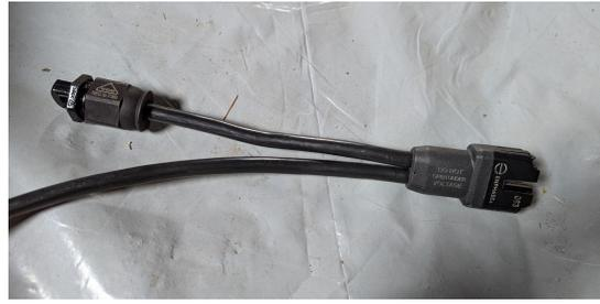
Danach das mitgelieferte AC Kabel (abisoliert vorbereitet, hierfür die kürzeren Litzen verwenden) und den Kabelverbinder nehmen.
